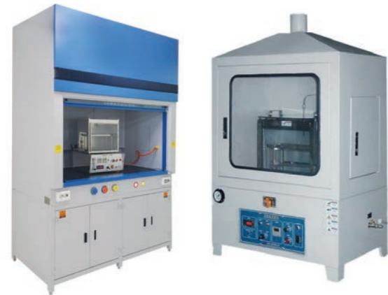
연소성 시험기 (Flammability Tester)
